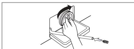
4. После очистки вставьте фильтр на место и, повернув его по часовой стрелке, плотно затяните.
