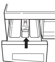
4. Вставьте выдвижной ящик в отсек и задвиньте его до упора. После окончания чистки включите стиральную машину в режиме полоскания.
