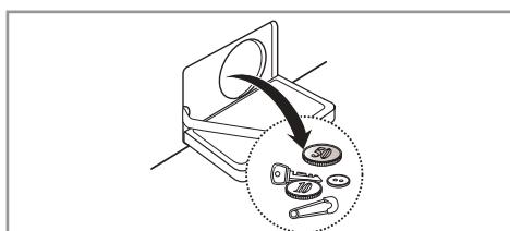
3. Осторожно отвинтите крышку дренажного насоса. Извлеките из дренажного насоса все посторонние предметы и ворс, промойте его изнутри.
