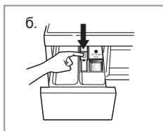
1. Нажав на стопорную защелку, извлеките выдвижной ящик из стиральной машины.
