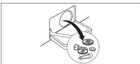
3. **B** Осторожно отвинтите крышку дренажного насоса. Извлеките из дренажного насоса все посторонние предметы и ворс, промойте его изнутри.
