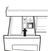
4. Вставьте выдвижной ящик в отсек и задвиньте его до упора. После окончания чистки включите стиральную машину в режиме полоскания.
