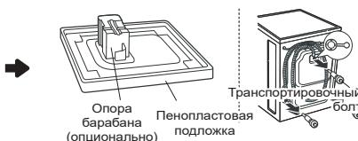
Снимите транспортировочные болты и опоры.
