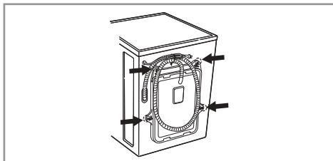
1. Для предотвращения повреждения внутренних деталей машины при транспортировке в машине закреплены 4 транспортировочных болта. Перед началом эксплуатации машины эти болты необходимо удалить вместе с резиновыми заглушками.
