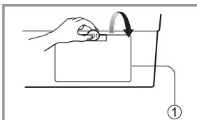
**2.** Выньте дренажную пробку (②), чтобы остатки воды стекли. Подставьте какой-нибудь сосуд, чтобы вода не попала на пол. Когда вода перестанет течь, откройте фильтр дренажного насоса (③), повернув его против часовой стрелки.
