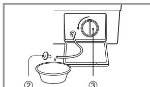
**3.** Выньте все посторонние предметы из фильтра (③). После чистки поверните фильтр (③) по часовой стрелке и вставьте на место дренажную пробку (②). Закройте дверцу на нижней панели.
