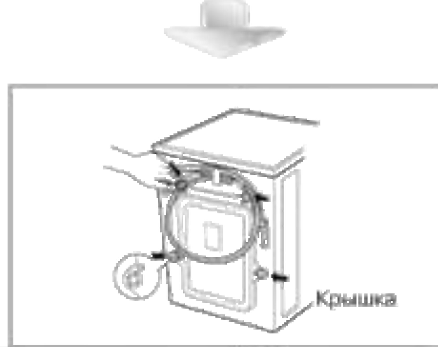
2. Отвинтите 4 болта при помощи гаечного ключа, который входит в комплект поставки машины.
