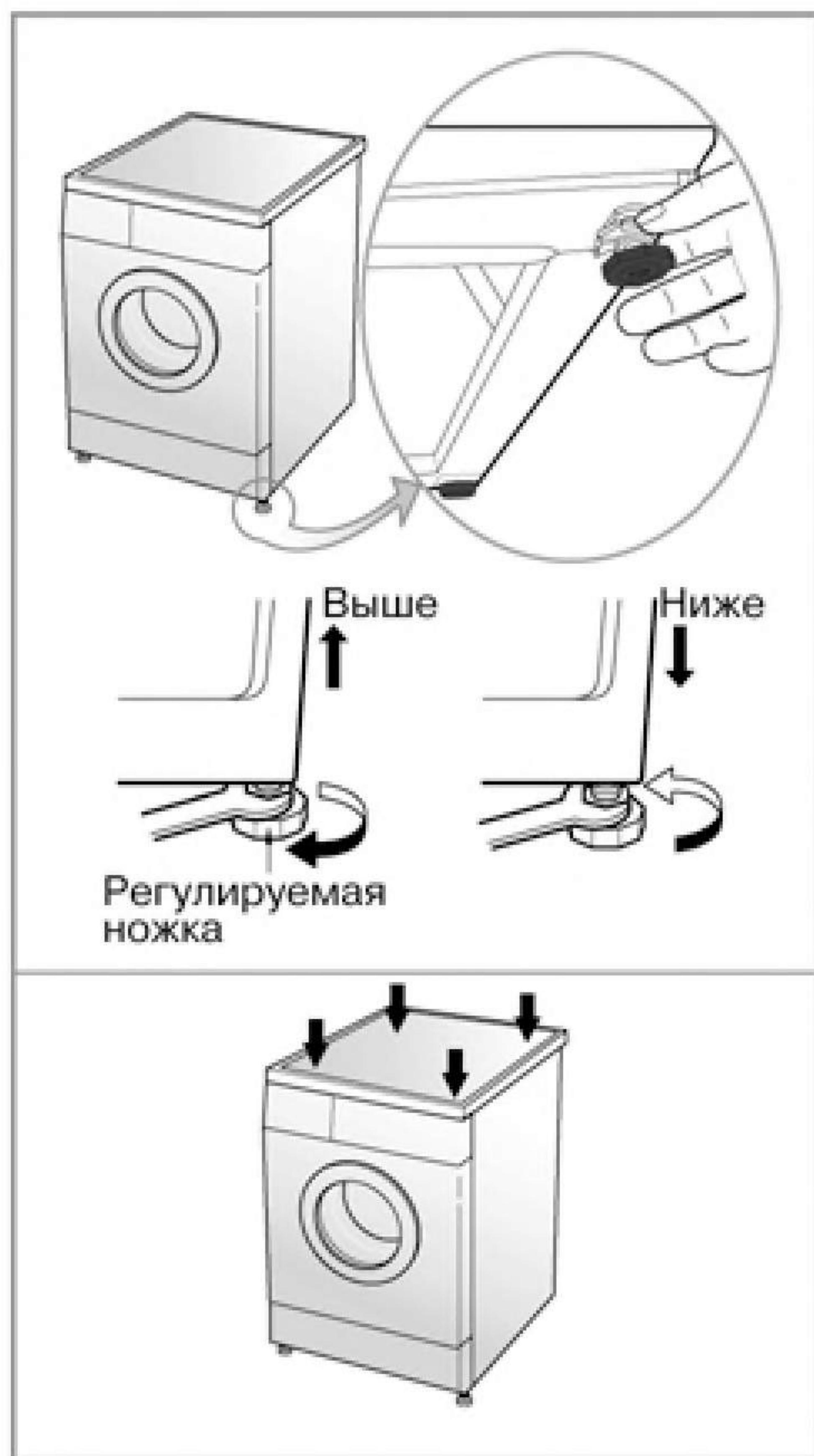
1. Для предотвращения вибрации и чрезмерного шума необходимо придать стиральной машине строго горизонтальное положение. Стиральную машину следует устанавливать на твердом, ровном полу, желательно в углу комнаты.
