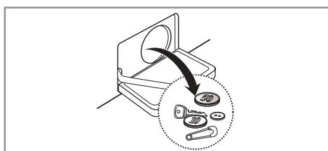
3. Осторожно отвинтите крышку дренажного насоса. Извлеките из дренажного насоса все посторонние предметы и ворс, промойте его изнутри.
