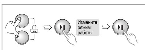
Режим блокировки от детей включается одновременным нажатием и удержанием в течение трех секунд двух кнопок, обозначенных символом “” .
