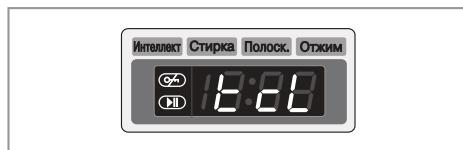
При включенном режиме Очистка барабана на дисплее отображаются буквы “**CL**”.
