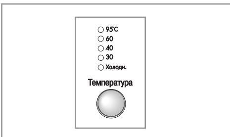
• Кнопка **Температура** предназначена для выбора температуры воды.
