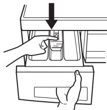
1. Нажав на стопорную защелку, извлеките выдвижной ящик из стиральной машины.
