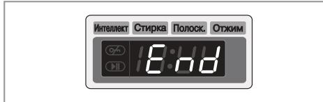
При завершении процесса стирки на дисплее отображается надпись “**End**”. Происходит автоматическое отключение стиральной машины.
