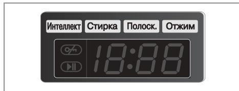
На панели управления находится дисплей, который отображает информацию о процессе стирки и состоянии стиральной машины.
