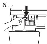
1. Нажав на стопорную защелку, извлеките выдвижной ящик из стиральной машины.
