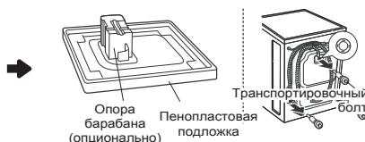
Снимите транспортировочные болты и опоры.
