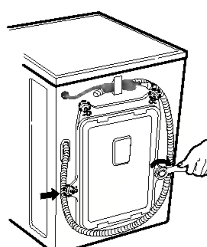
2. Отвинтите 4 болта при помощи гаечного ключа, который входит в комплект поставки машины.
