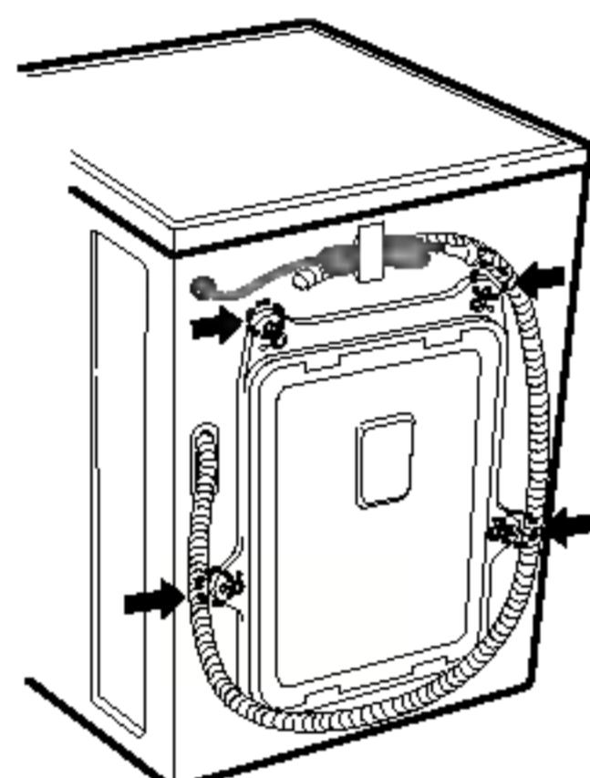
1. Для предотвращения повреждения внутренних деталей машины при транспортировке в машине закреплены 4 транспортировочных болта. Перед началом эксплуатации машины эти болты необходимо удалить вместе с резиновыми заглушками.
