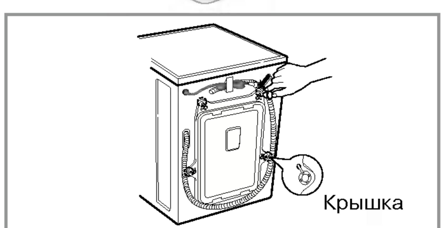
4. Закройте отверстия прилагаемыми крышками.
