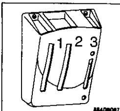
В камере для дозировки моющего средства имеются 3 емкости
