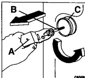
4. Отвинтить два болта (B) на задней стенке машины с помощью специального ключа (A) и снять две прокладки (C).
