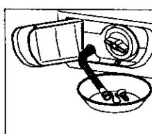
2. Затем нужно вынуть небольшой сливной шланг, положить его в плоский установленный на полу сосуд. Чтобы полностью опорожнить машину, нужно вынуть пробку.
