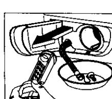
3. Повернуть фильтр против часовой стрелки и тщательно очистить его под струей воды. Снова вставить фильтр в держатель и повернуть его по часовой стрелке. Плотно вставить пробку и после этого закрыть крышку.
