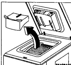
3. Открыть крышку машины и удалить прокладку, блокирующую барабан.
